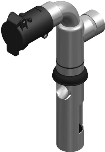
Pré-separador prático de líquidos, para coleta em bidons de óleo. Para ser colocado no orifício do tampão (R2") de um bidon de óleo vazio, mas adequado. Basta conectar a unidade às mangueiras de ar comprimido e de aspiração e está pronta para uso. A bola flutuante embutida interrompe a sucção quando o tambor estiver cheio.
