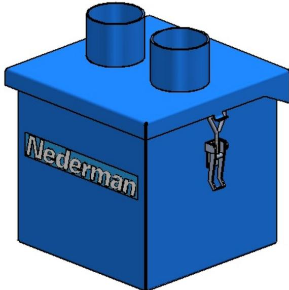
Num sistema de limpeza central pode ser conveniente proteger o sistema de condutas e o filtro de parafusos, porcas e outras peças maiores e pesadas que possam ser extraídas no processo. O GA8 é um pré-separador pequeno e leve que captura as peças maiores e pesadas antes que elas entrem no sistema de condutas. Um GA8 deve servir um ponto de sucção.
